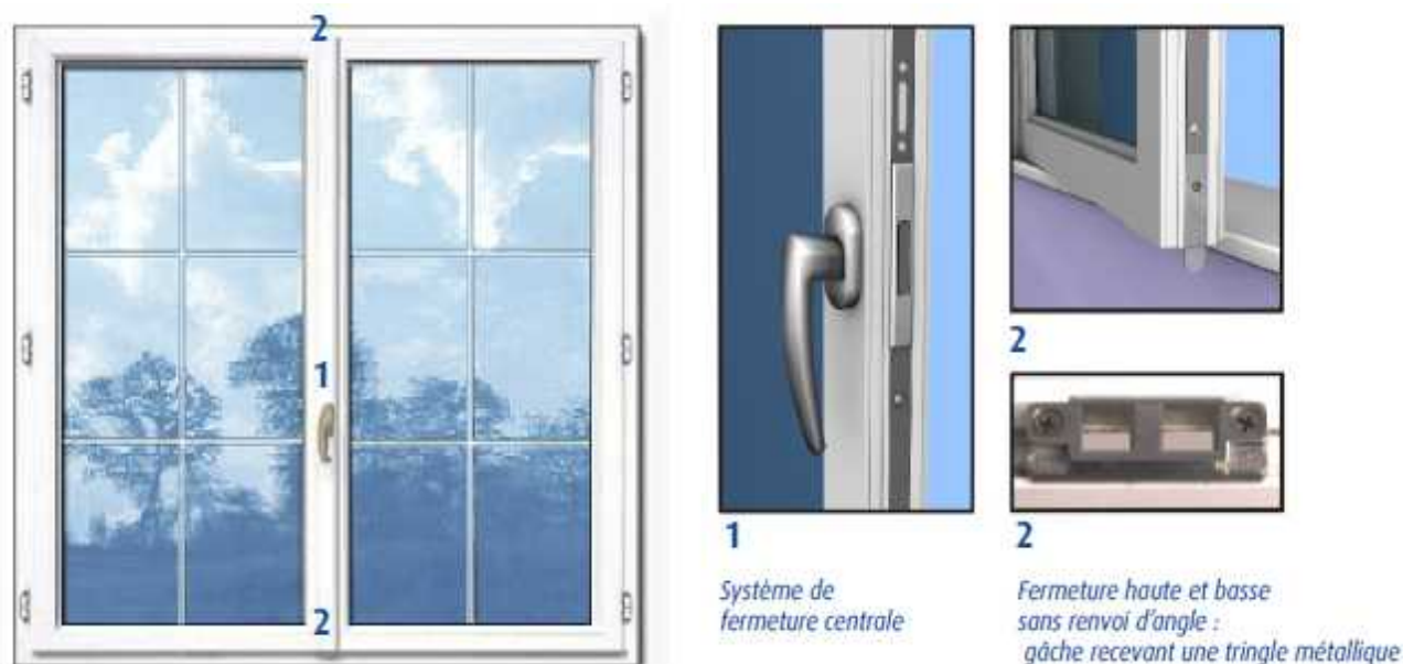
Illustration 39 : Système de fermeture classique à crémone 3 points avec sortie de tringle (sans renvoi d'angle) d'une fenêtre à ouverture à la française
