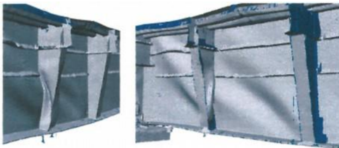
Figure 6 : Nuage de point du relevé lasergramétrique - Source : SITES
