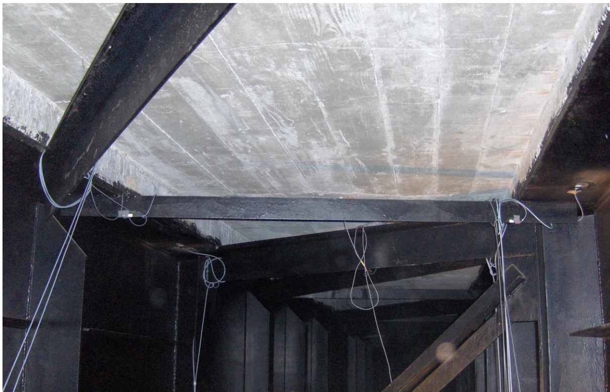
Illustration 22: Photo de l'instrumentation de la cornière
