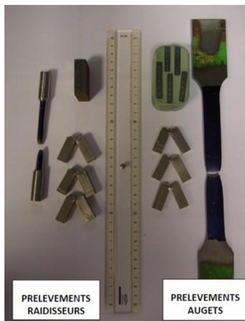
Figure 8 : Jeu d'éprouvettes par type de prélèvement - Source : LHEM
