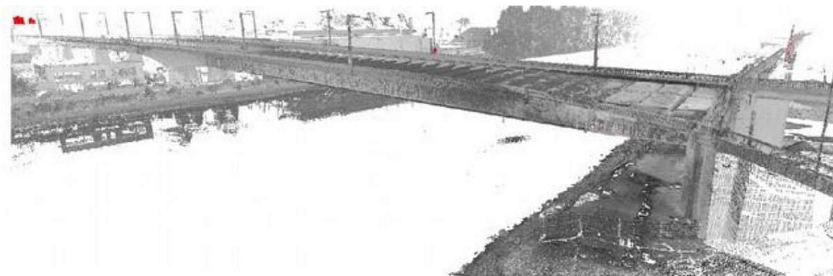
Figure 6 : Nuage de point du relevé lasergramétrique - Source : SITES
