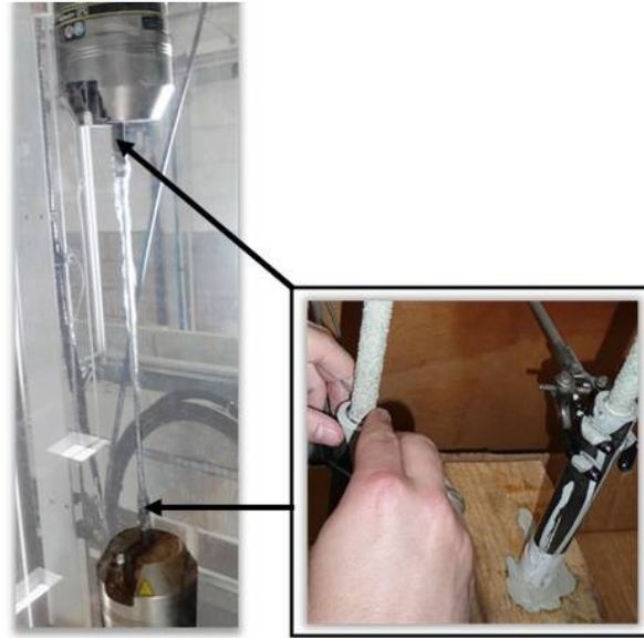
Figure 4 : Montage de l'essai de traction et dispositif spécifique d'ancrage
