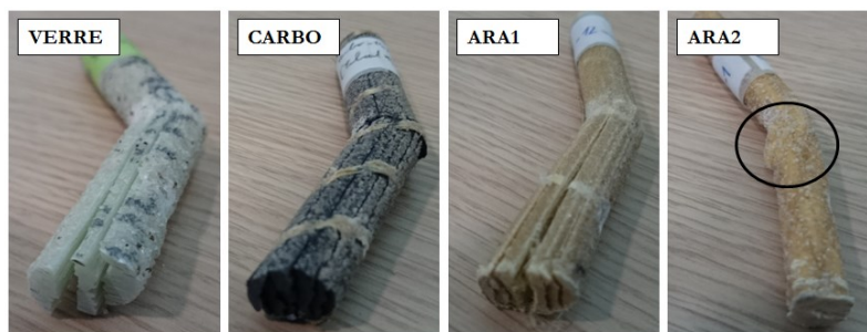
Figure 12 : Modes typiques de rupture des armatures PRF lors des essais Short-beam test
