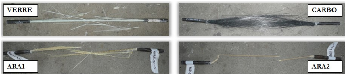
Figure 9 : Modes de rupture typiques des armatures en PRF en traction
