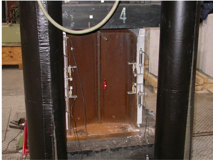
Figure 13 : mesures du glissement par capteurs de déplacement
