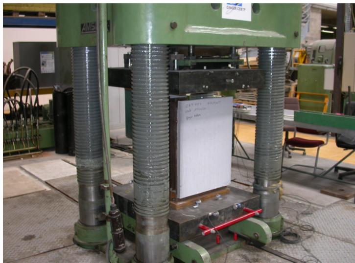
Figure 12 : presse d'application du chargement - Essais Push-out
