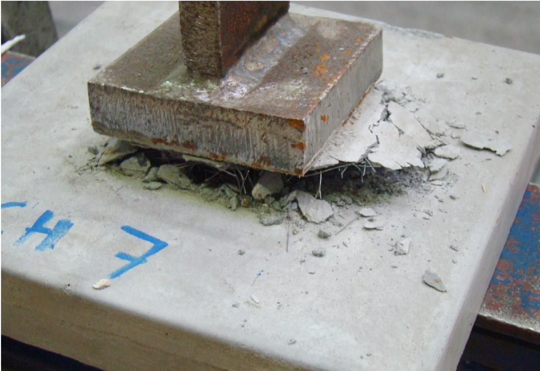
Figure 20 : mode de ruine des éprouvettes au cours des essais d'arrachement
