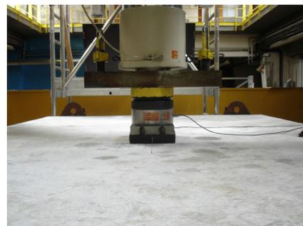
Figure 6 : schéma du montage en configuration roue(s) et aperçu des chargements de type plaque(s)
