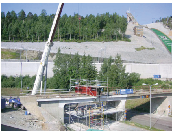
Figure 8 : Essai de chargement (a) du pont d'Örnsköldsvik (Suède) et cartographie d'endommagement (b) obtenue pour un déplacement imposé égal à 100 mm
