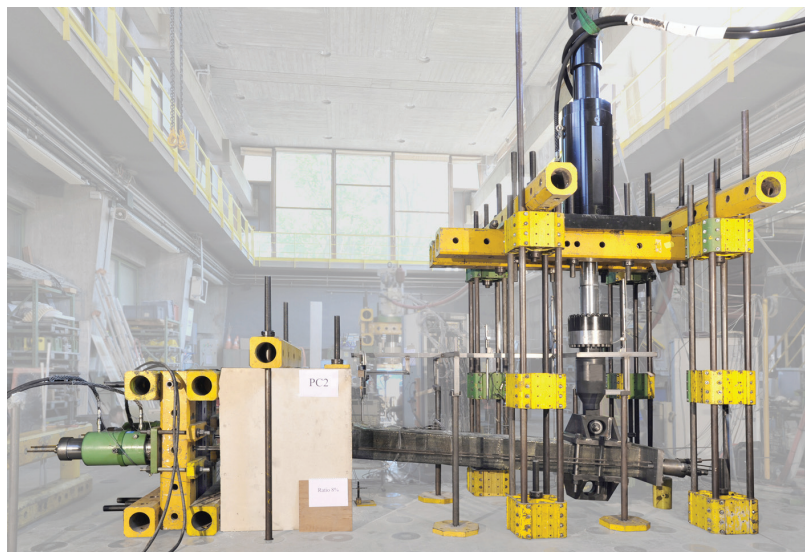
Figure 6 : Comportement d'un corps d'épreuve renforcé par PRF sous sollicitations cycliques alternées
