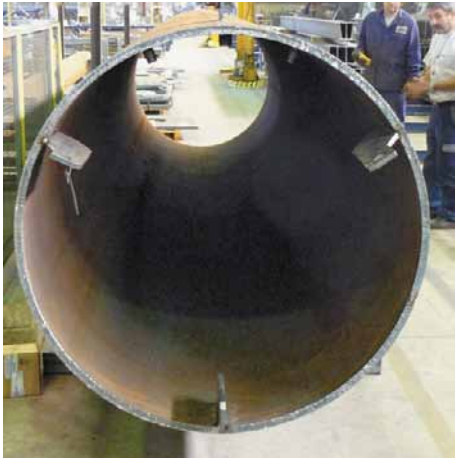
Photo 10 : appendices de réglage des éléments entre eux – Source : André Moutengou (DIRA)
