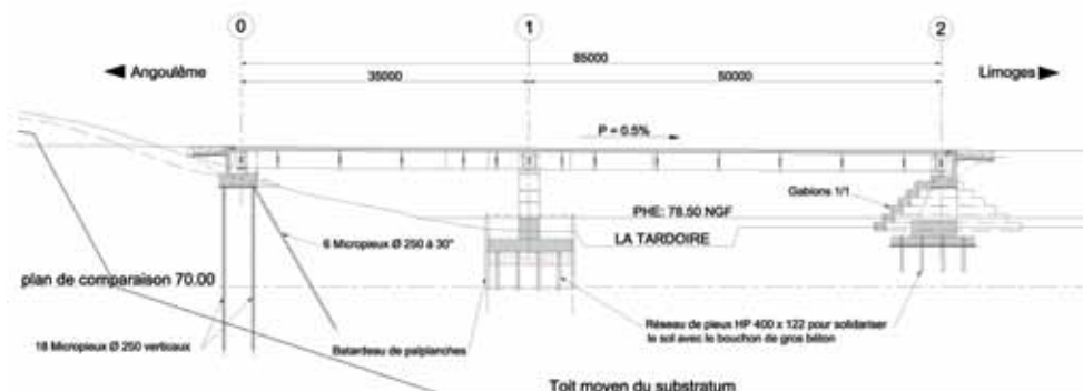
Figure 4 : coupe longitudinale – Source : DOA du CETE du Sud Ouest
