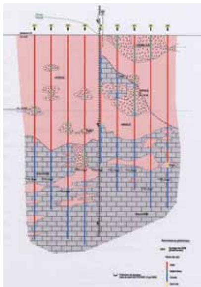
Figure 17 : interprétation des sondages destructifs en phase d'exécution Profil en travers de la ligne arrière (LRPC de Bordeaux - juin 2009)
