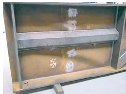
Figure 3 : voilement de cisaillement dans les panneaux testés – Source : COMBRI 2006
