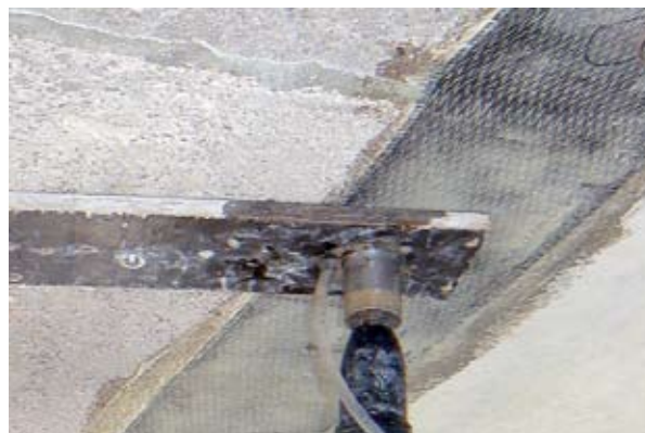
Photo 24 : préparation d'un essai de traction sur composite collé – Source : LRPC d'Autun
