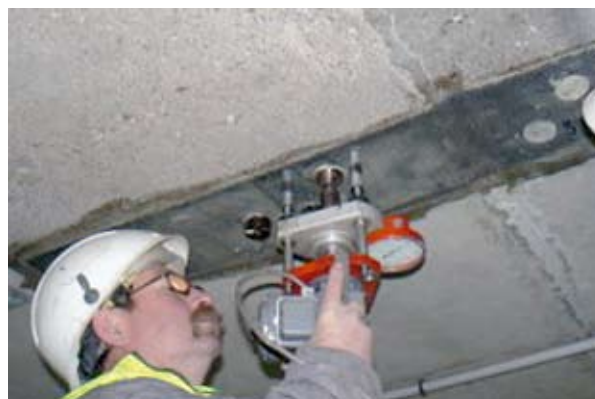
Photo 25 : essai de traction sur composite collé – Source : LRPC d'Autun
