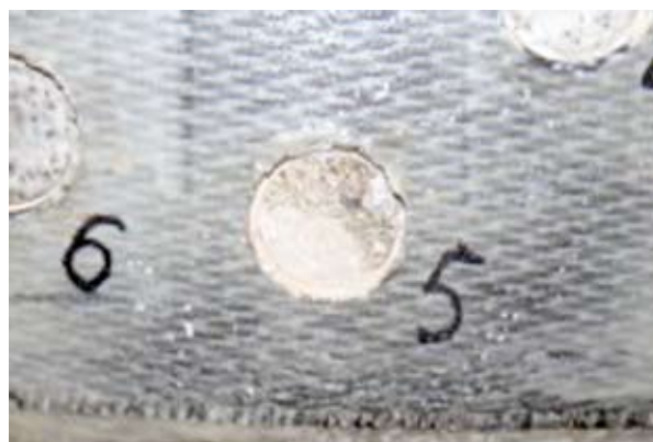
Photo 26 : résultat d'un essai de traction sur composite collé Source : LRPC d'Autun
