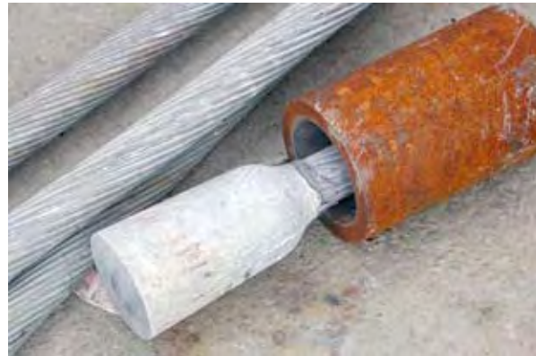
Photo 7 : douille et cône de zinc – Source : Patrick Losset (CETE du Sud-Ouest)
