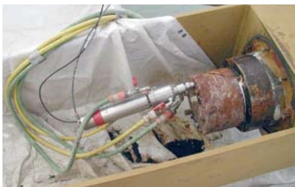
Photo 10 : buses d'injection de solution inhibitrice à la base des culots – Source : Pierre-Marie Dubois, Daniel Michaux (PMD - ATEAV Systems)
