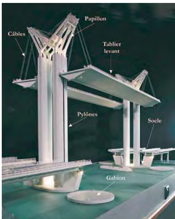
Figure 7 : éléments constitutifs de l'ouvrage – Source : DDE 76
