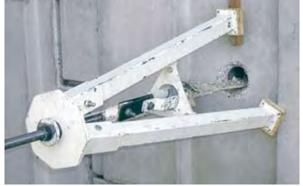
Photo 3 : trépied d'extraction des témoins – Source : Jean-Marc Jailloux
