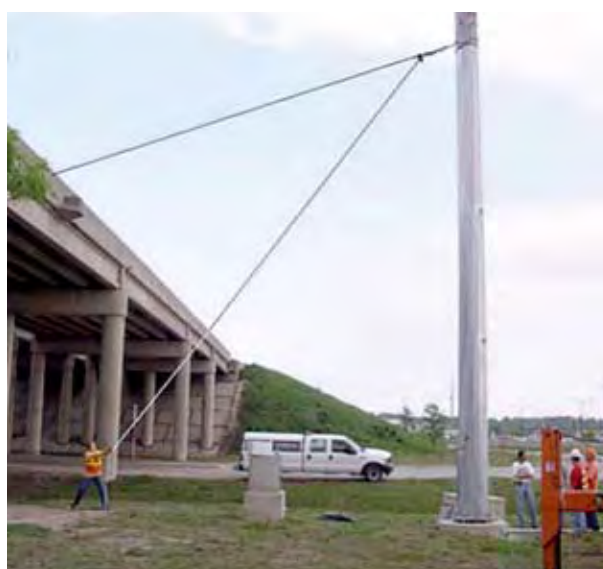
Photo 2 : test dynamique expérimental, en Iowa – Source : Bruce Brakke
