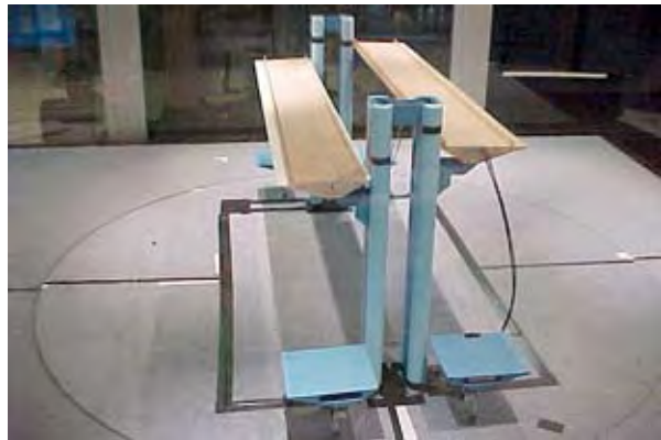
Photo 1 : essais en soufflerie – Source : groupement MOE
