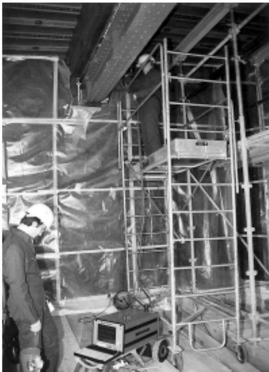
faces ne permettant pas d'assurer l'absence de contamination de la chambre d'analyse par l'oxygène environnant (le cas échéant, les mesures étaient reproduites sur une zone voisine). Ces investigations ont été complétées par des mesures de dureté Vickers sur la totalité des poutres, dans les mêmes zones que celles concernées par les analyses chimiques.
