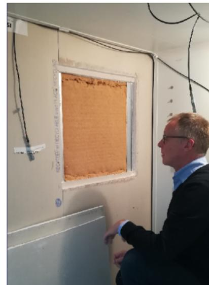
À l'intérieur de la cellule expérimentale aux paramètres hygrothermiques contrôlés, l'Université de Picardie (ci-dessus Thierry Langlet) s'apprête à prélever une partie de l'isolant de la paroi.
