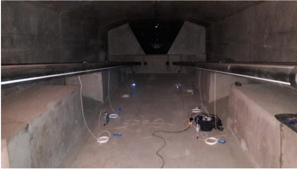
Mise en place des capteurs sur les câbles
