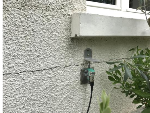
Fissure instrumentée dans MACH | Ighil Ameur © Cerema 2020
