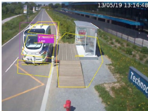
Figure 19: Illustration des zones de détections à l'arrêt Technocampus (source : Lacroix City)
