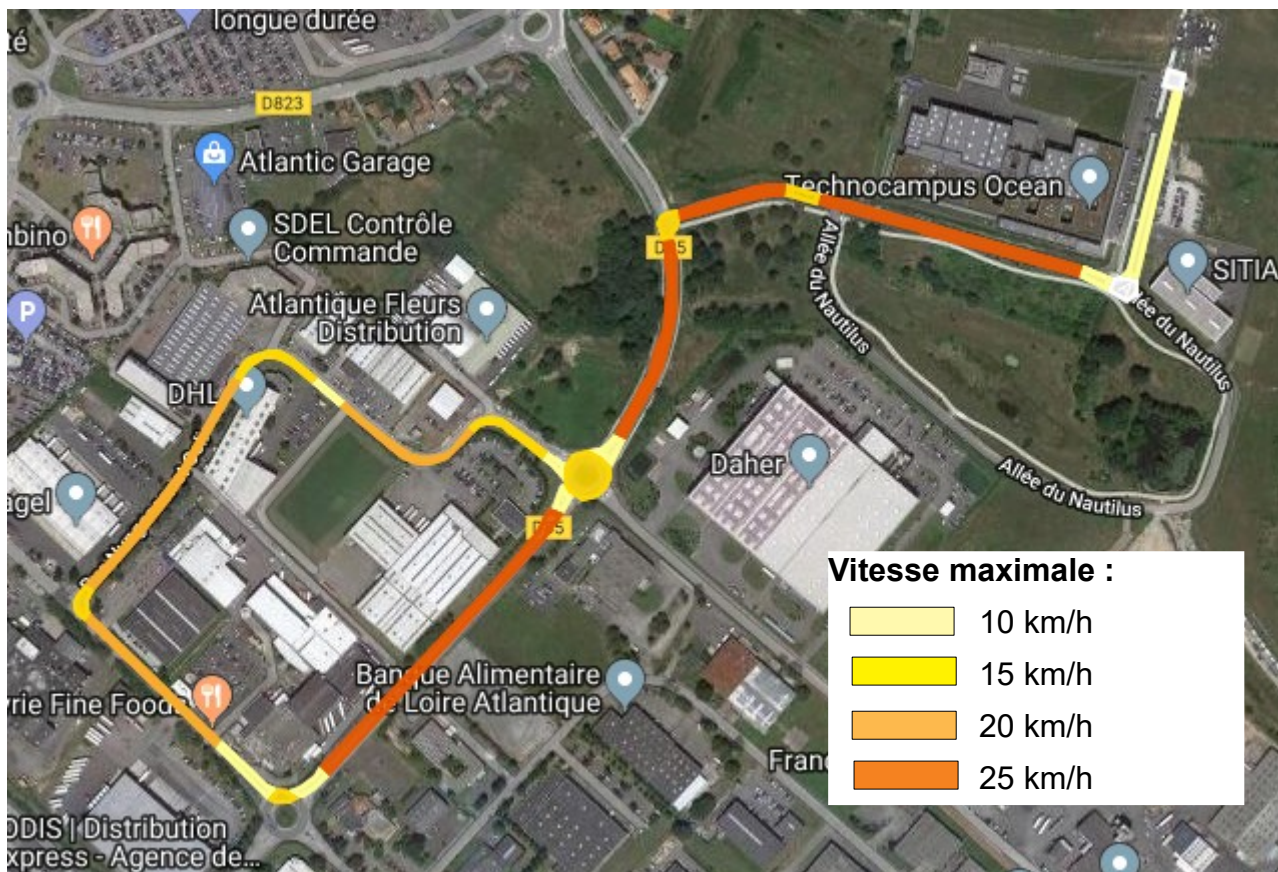
Figure 8: Profil des vitesses souhaitées de la navette autonome (Source : SEMITAN)
