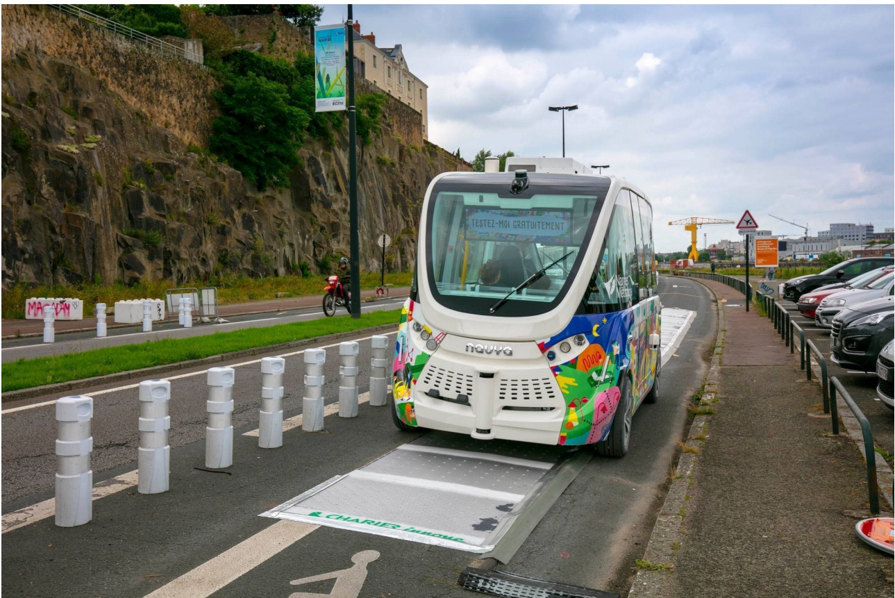
Figure 3: Photo de la navette autonome et de la route photovoltaïque lors de la première expérimentation (Source : https://www.charier.fr/images/innovation/innovation_envir_navette.jpg )
