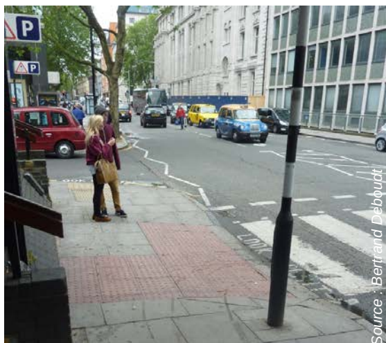
Pavage tactile en L, en amont des passages pour piétons.
