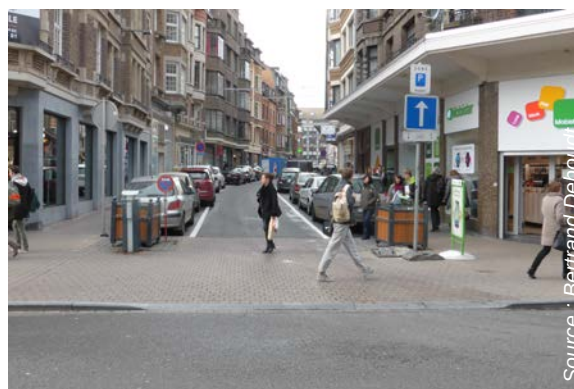
Traverser des rues latérales sans différence de niveau : plateau avec traversée (photo à gauche) ou trottoir traversant (photo à droite) ; Bruxelles, Namur.
