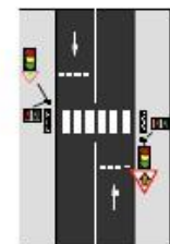
Feu passage piétons ou lors de phase piétons intégrale
