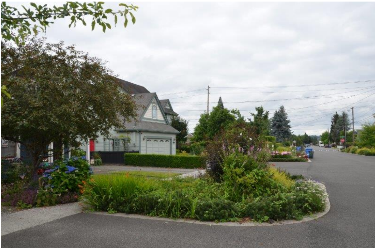
Illustration 25 : De nombreux aménagements participent à l'amélioration du cadre de vie et à la gestion du ruissellement. La photo ci-dessus présente un aménagement intégrant du minéral sous la forme de galets, accompagné de graminées et de bruyères. Ci-dessous, à proximité, les jardins de pluie sont essentiellement plantés d'arbustes bas. Crédits : Cerema.
