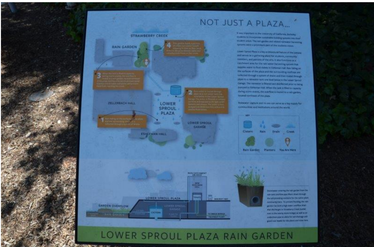
Illustration 41: Panneau pédagogique présentant le schéma du système de gestion de l'eau pluviale de la place "Lower Sproul Plaza" de l'Université de Berkeley. Crédit : Cerema.
