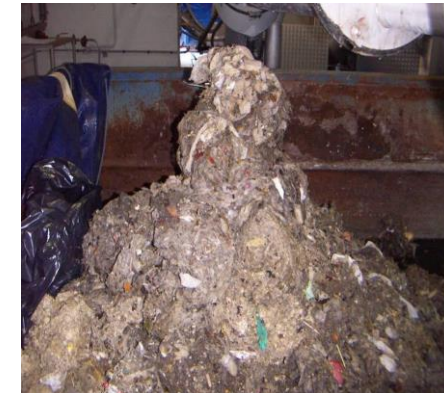
Refus de dégrillage (Crédit : Le Hyaric, 2009)
