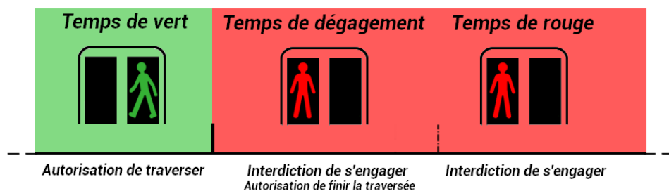
Illustration 63: Schéma de fonctionnement des feux bicolores classiques.
