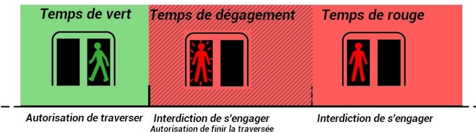
Illustration 65: Schéma de fonctionnement des feux avec rouge clignotant.
