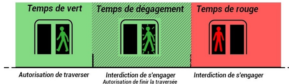
Illustration 64: Schéma de fonctionnement des feux avec vert clignotant.
