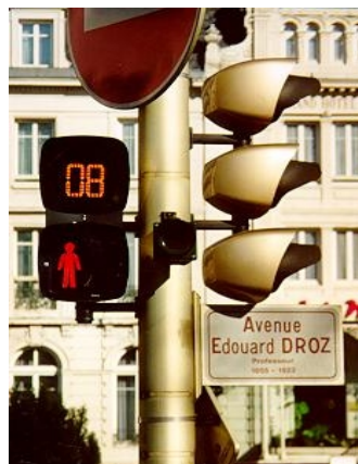
Illustration 48 : Dispositif Sécurifeu. (source : Rapport d'étude Sécurifeu)
