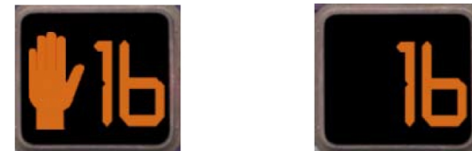
Illustration 52: Affichage classique aux USA (à gauche) et affichage expérimental (à droite). (source : rapport de l'étude)
