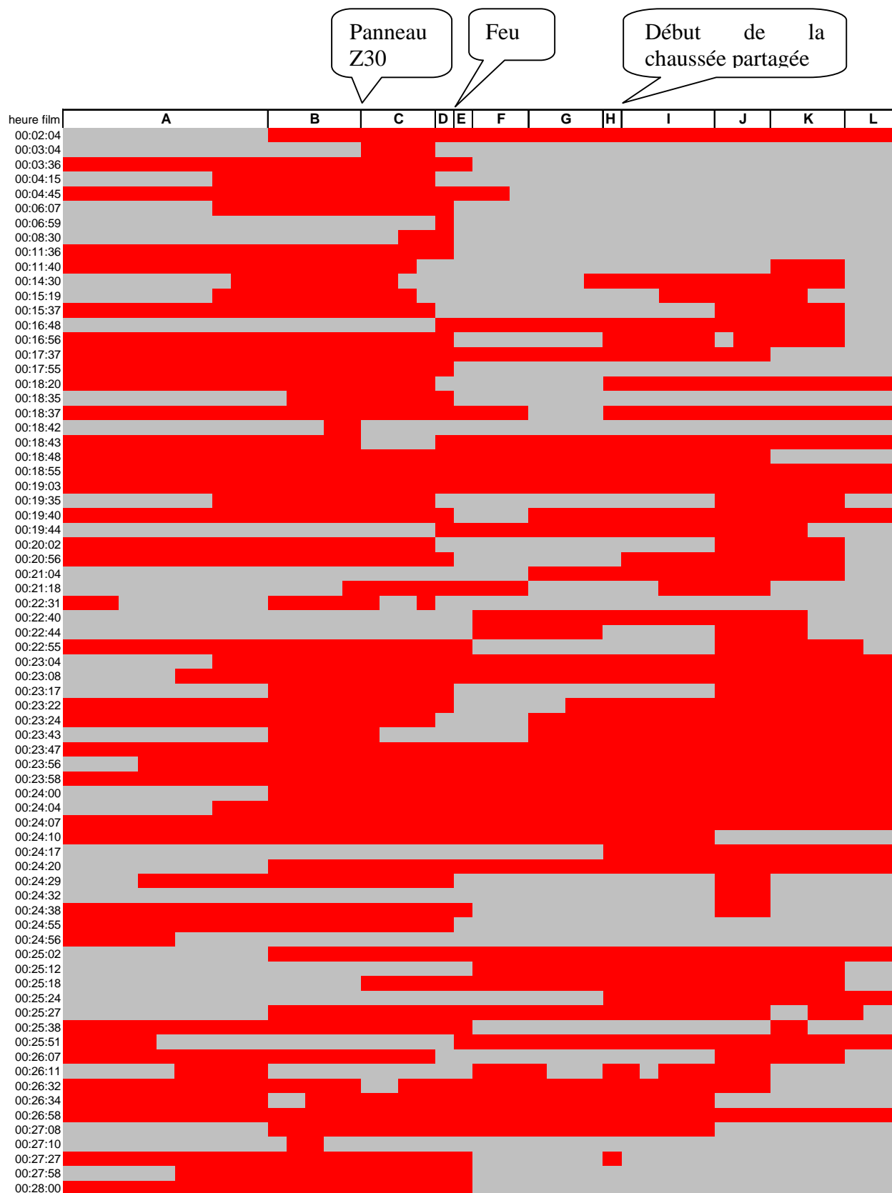
Figure 50 : Lieux de freinage des véhicules observés après installation du feu
