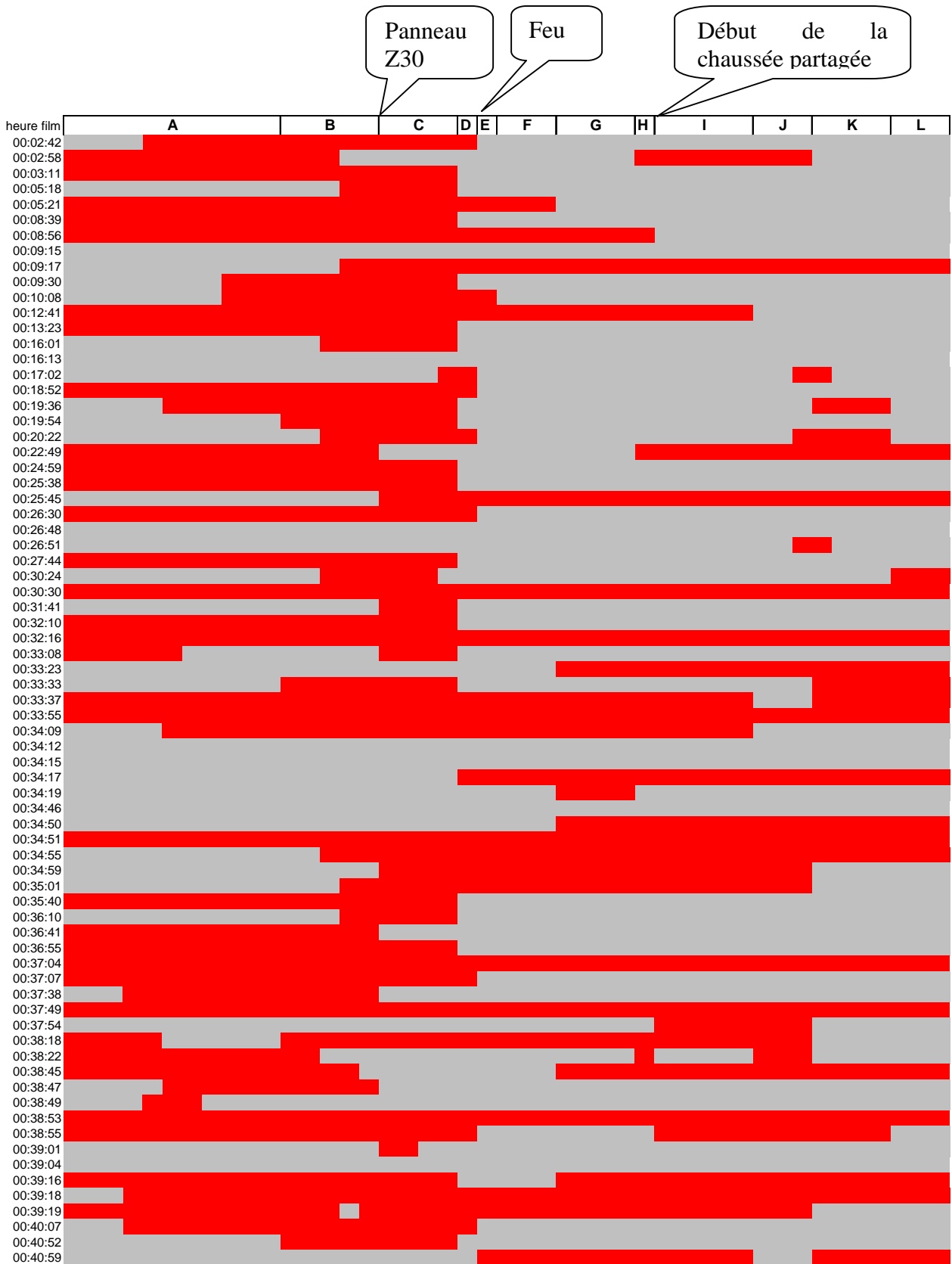
Figure 56 : Lieux de freinage des véhicules observés un an après installation du feu
