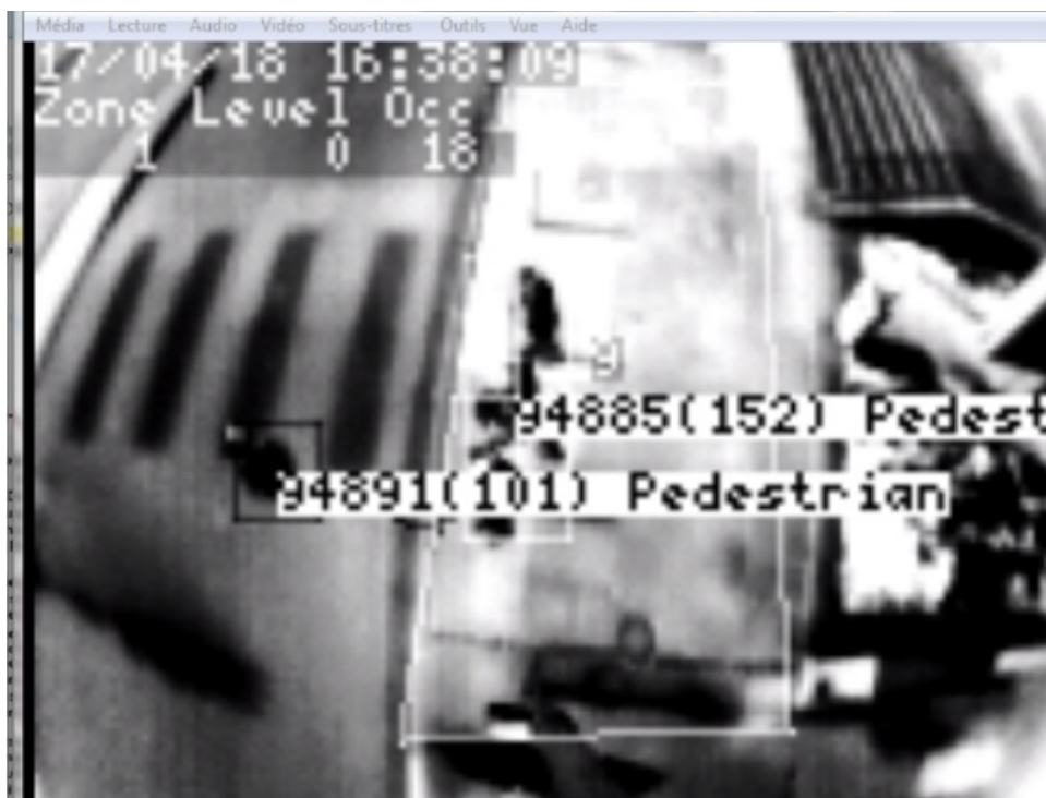
Illustration 12: Image issue du capteur TrafiOne. On peut apercevoir en haut à gauche la date, l'heure, le numéro de la zone, et surtout le taux d'occupation de la zone en temps réel (noté « Occ »). A cet instant précis, les piétons occupent 18 % de la zone d'attente définie. Cette zone est représentée par le rectangle blanc.
