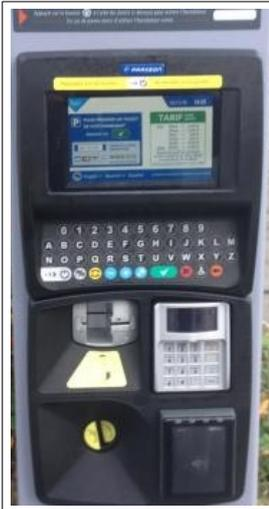
*Les nouveaux horodateurs de Brest prennent la carte avec ou sans contact et enregistrent l'immatriculation: le contrôle se fait via le scan des plaques des voitures garées et interrogation de la machine. On peut prolonger son temps sur n'importe quel horodateur de la même zone tarifaire, et l'objet permet aux résidents de payer la vignette délivrée par la collectivité (source Ouest France)*
