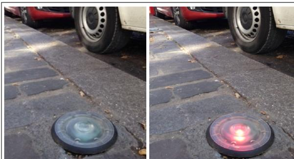
Visuel de capteur mis en place pour contrôler le temps passé sur les aires de livraison de la ville de Cannes en émettant un signal lumineux par LEDs (société oneSITU)
