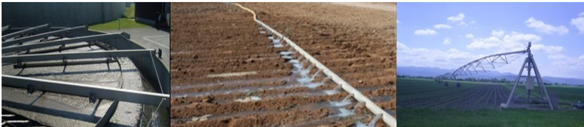
Photo (C. Néel, Cerema ©) : cas de Clermont-Ferrand : réacteur à boues activées de la STEU (à gauche), asperseur utilisé avec les EUT (à droite). cas de Sfax, Tunisie (au centre) : mode d'irrigation à la raie par les EUT pour des cultures associées (céréales, oliviers).
