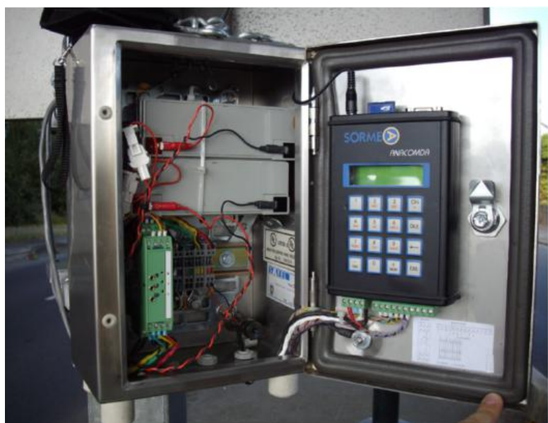
L'ANACOMDA se compose d'un boîtier d'enregistrement, d'un capteur Doppler et de capteurs optiques
