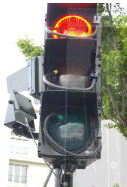
L'ANACOMDA se compose d'un boîtier d'enregistrement, d'un capteur Doppler et de capteurs optiques
