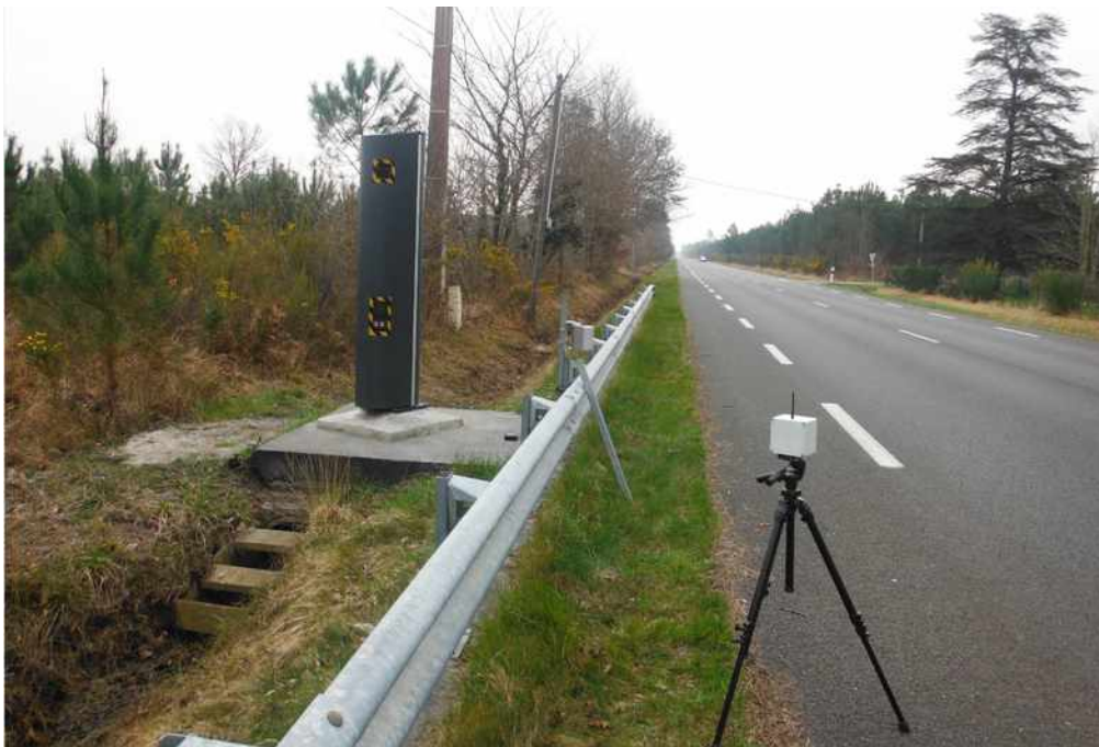
ET2F sur la RD6 - réglage du Viking au droit de l'équipement
