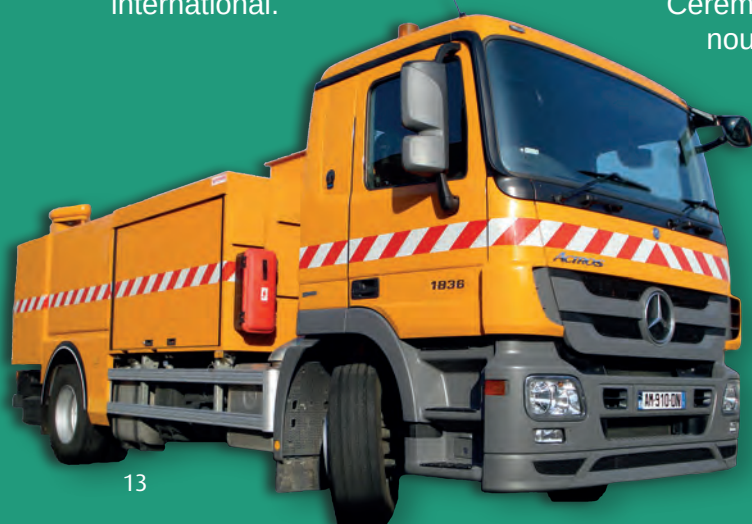
SCRIM : (Essais routiers : mesure de glissance chaussée mouillée à 60 km/h)
