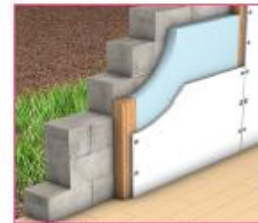
Exemple d'isolation par l'intérieur
