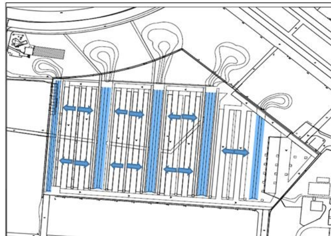
1 - Pluies de retour < 3 mois : recueil et infiltration lente par les noues
