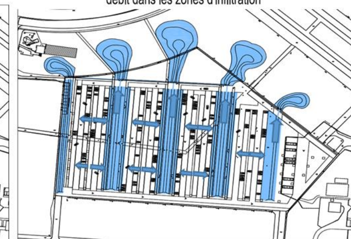
4 - Pluies centenales : les pluies peuvent inonder les pieds des stationnements et les boisements
