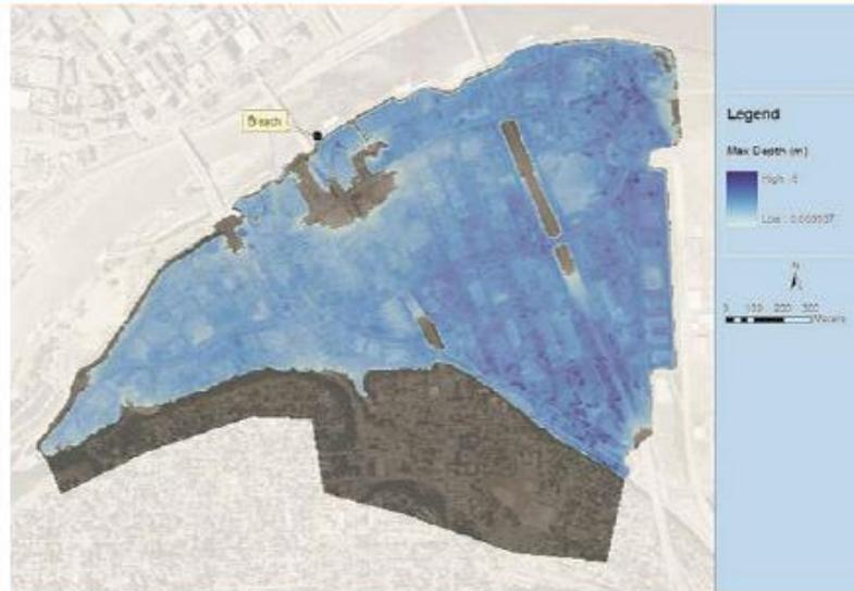
Exemple d'une cartographie des hauteurs d'eau maximales générée par RFSM, montrant l'inondation résultant d'une brèche dans une digue protégeant une zone urbanisée dans le lit majeur
