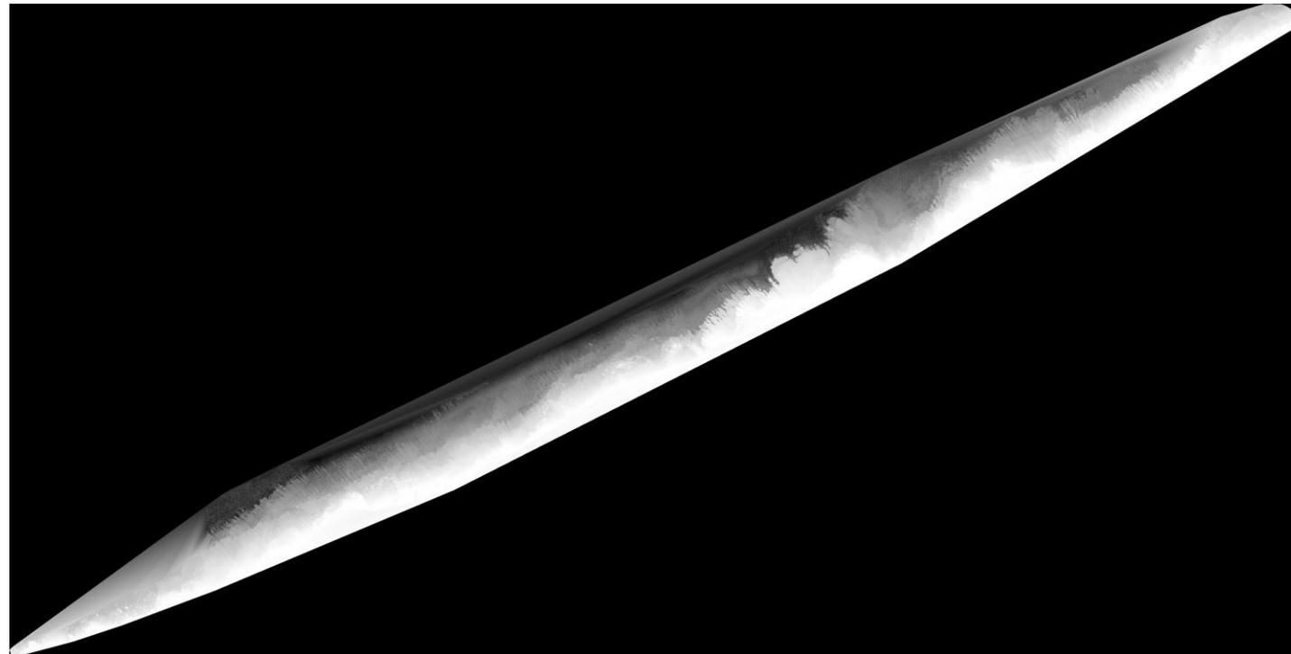
***Détection automatique : extraction fissures sur platier par filtre de Sobel (Matlab)***
