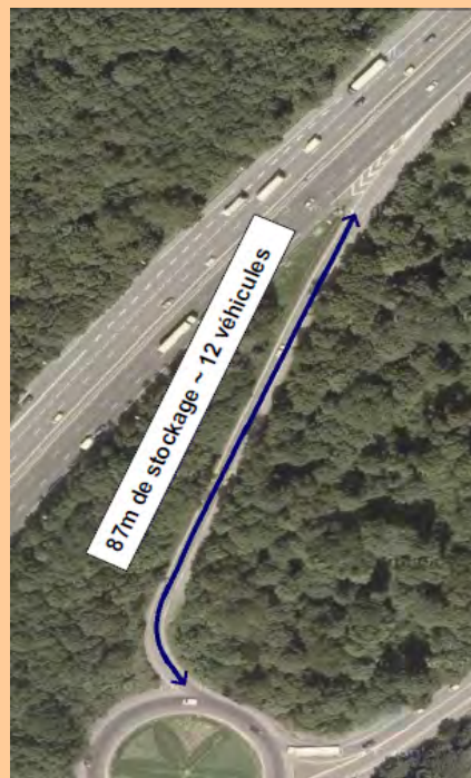
Exemple 7 : Mesure de longueur de la bretelle
