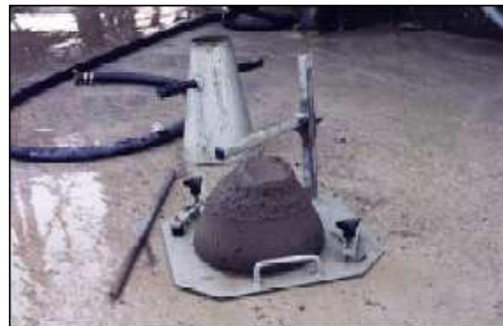
Essai d'affaissement au cône d'Abrams
