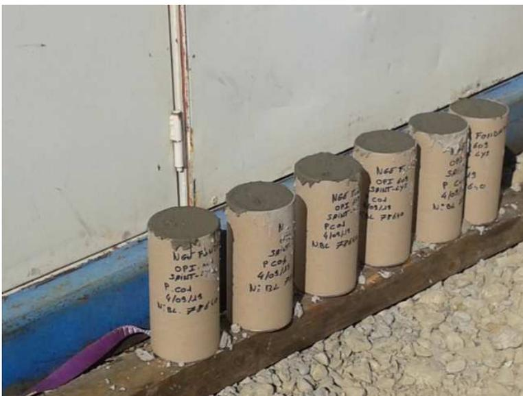
Prélèvement du béton de la toupie avant le bétonnage du pieu
