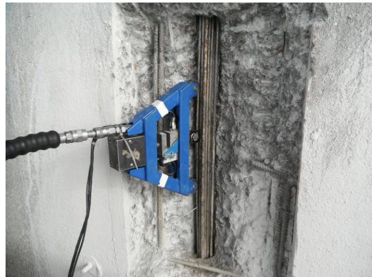
Test à l'arbalète sur pile
