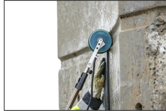
Canin (Proceq) – roue d'électrodes
