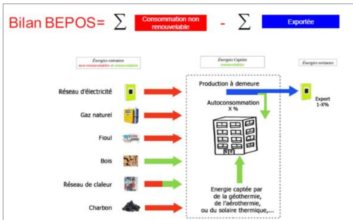
Le référentiel E+C- évalue la performance énergétique d'un bâtiment par l'intermédiaire de quatre niveaux de performance : Energie 1 / Energie 2 / Energie 3 / Energie 4. Voici les seuils correspondants par usages :
