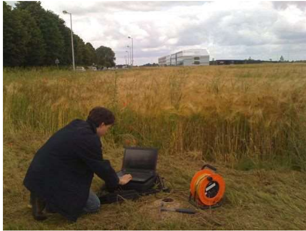
Figure 41: Téléchargement des données des sondes autonomes
