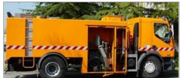
El Scrim mide con alto rendimiento la adherencia y los perfiles de la calzada.
