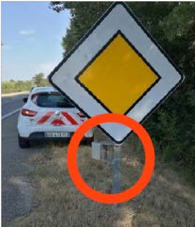
Radar Viking poco visible. Permite medir velocidades reales.
