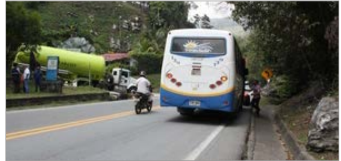
Parada sin visibilidad a la salida de una curva y frente a una entrada.
