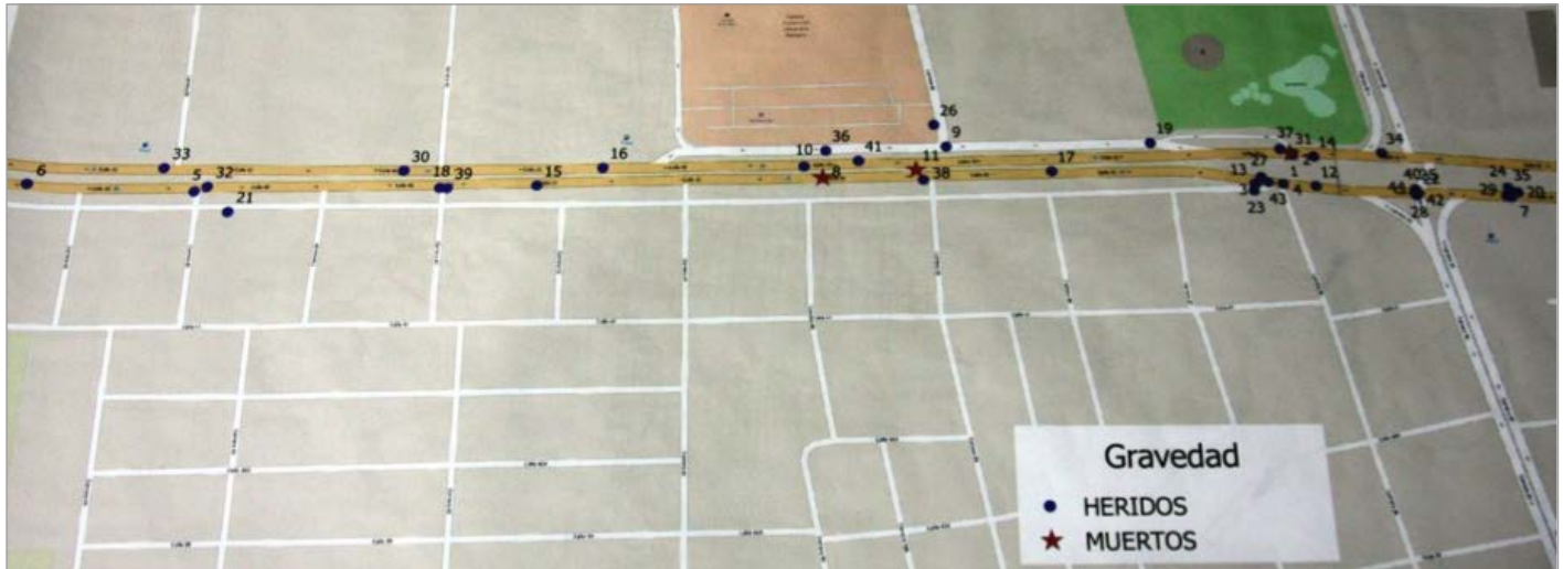
Plano del tramo objeto de estudio con los siniestros viales con víctimas (georreferenciados)
