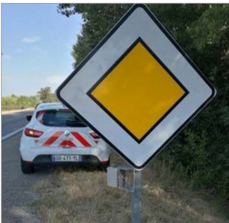
Radar Viking, difícil de detectar y que permite medir velocidades reales.
