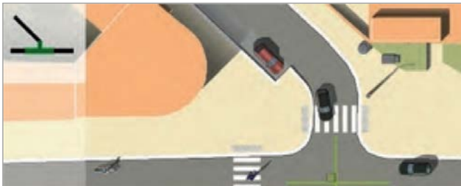
Intersección acondicionada en forma ortogonal para una mayor visibilidad y reducción de la velocidad a la entrada y salida de la intersección.
