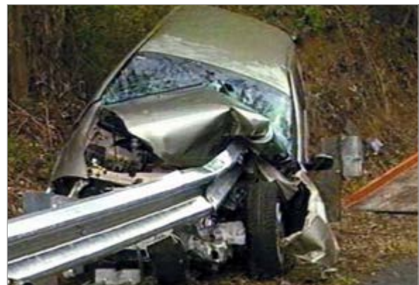
Choque con terminal de baranda en cola de pescado.
