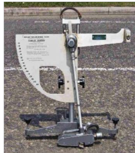
El péndulo SRT mide puntualmente la adherencia de la vía.
