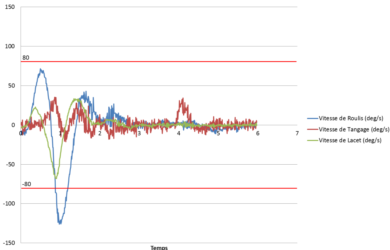
Figure 15 : Évitement vers la Gauche – 3 ème Essai à Vitesse Maximale Évolution des 3 vitesses de rotation en fonction du temps
