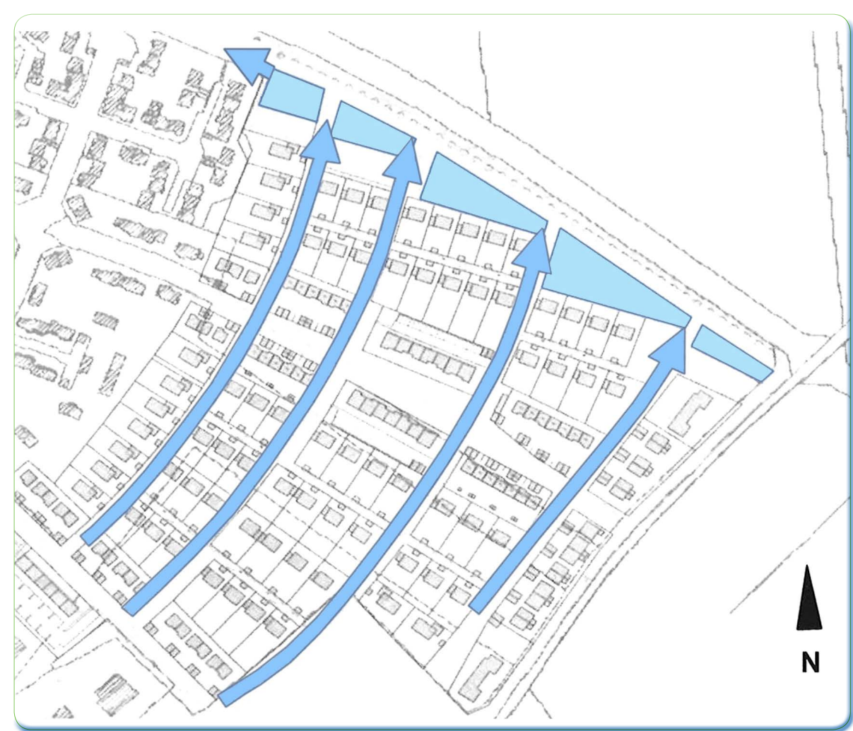
Cheminement de l'eau, des noues vers les bassins
