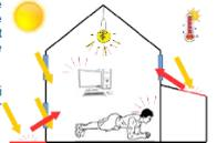
**Les apports internes** : il s'agit de la chaleur dégagée par les équipements électriques et par les occupants. Pour les premiers, il faut limiter leur usage au maximum (éteindre son ordinateur quand on s'en va, éteindre les périphériques inutiles, éviter d'allumer l'éclairage, etc.). Pour les seconds, évitez de faire votre séance de sport dans le bureau. 😊
