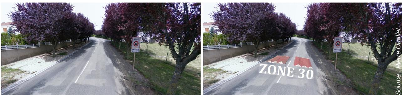
**figure 79** : une entrée en zone 30 qui pourrait être améliorée par du marquage au sol et des surélévations (plateaux, ralentisseurs trapézoïdaux, coussins berlinois).
