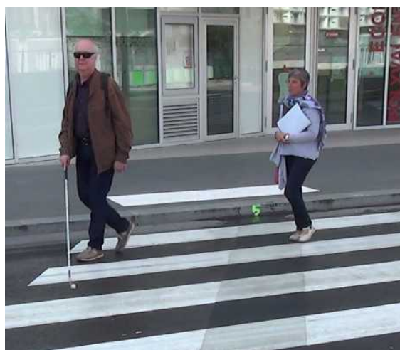
Illustration 10: Le produit 5 n'est détecté par aucun testeur et un seul testeur arrive à le suivre en traversée
