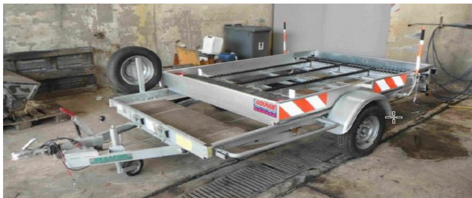
Illustration 5: A gauche, le premier système d'aide à la pose des bandes conçue et fabriquée par la DIR Nord. En haut, le second système, une remorque conçue et fabriquée par la DIR Nord pour la pose et le stockage des bandes.
