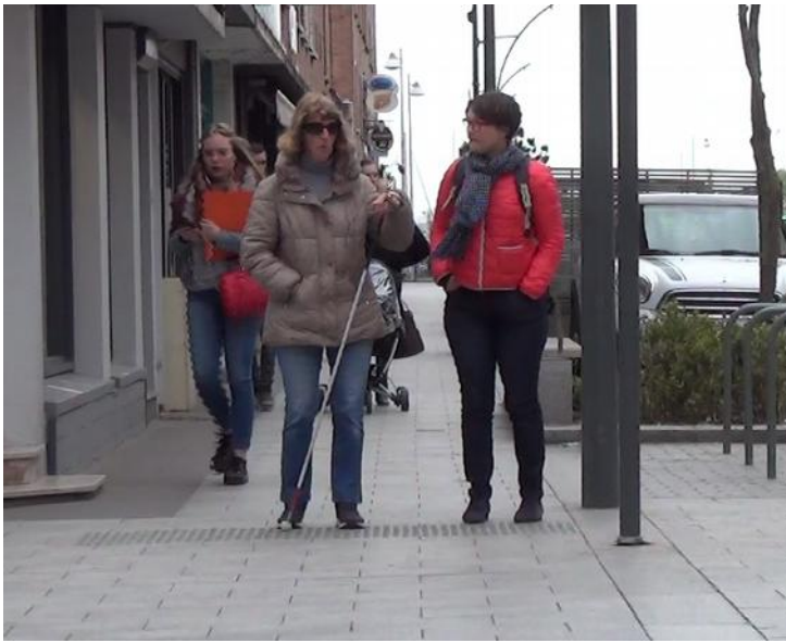
Illustration 11: Au niveau de T2, le testeur détecte la BEV à la canne et confirme l'information aux pieds
