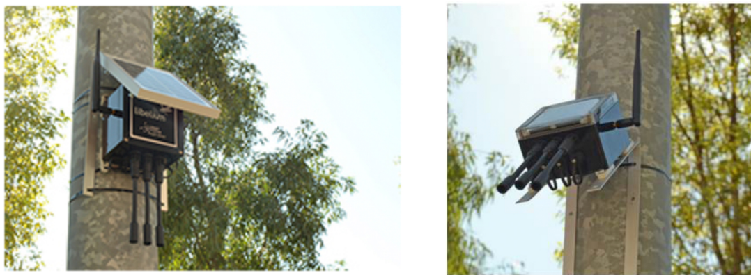
FIGURE 1.3 : Image d'un capteur de qualité de l'air (particules fines, O_3 , NO_2 ) - Site du constructeur : Libelium - http://www.libelium.com
