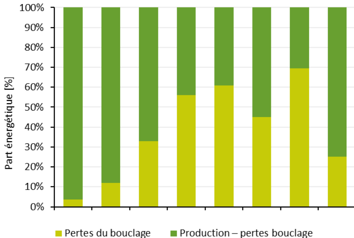
Pertes thermiques liées au bouclage
